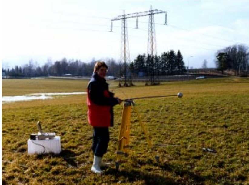
Ellen Røhne måler elektrisk felt fra en 300 kV kraftledning som en del av hennes hovedfagsoppgave
